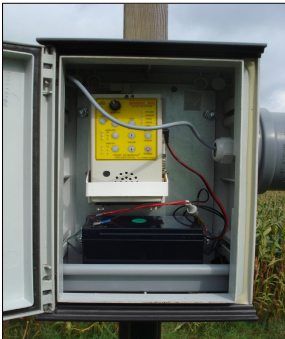
Abb. 2a und b: Aufbau der Anabat-Technik in Sellen 2012
