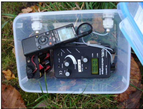
Abb. 1a und b: Aufbau einer Horchkiste
