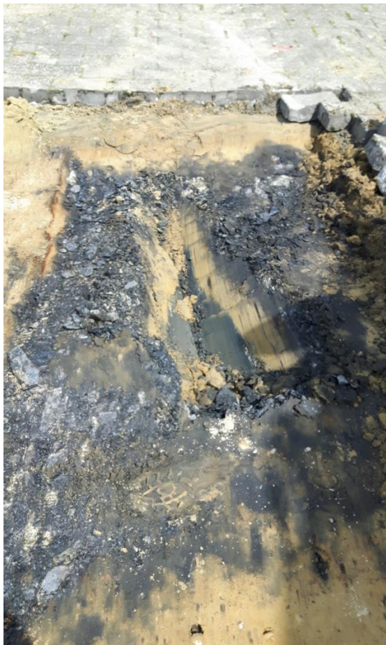
Abbildung 2+3: Fotos vom 18.06.2019, Blickrichtung Heckenweg auf die angetroffenen Verfärbungen im Bereich der südöstlichen Zufahrt, hängt mit den Verfärbungen aus Abb.1 zusammen, rechts im Bild der Schichtenaufbau (in die Baggerschaufel hineinfotografiert), geruchliche Auffälligkeiten (KW-Geruch, KP Zufahrt SO entnommen) in der unteren Bodenschicht
