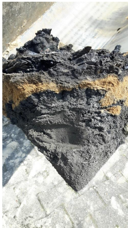
Abbildung 2+3: Fotos vom 18.06.2019, Blickrichtung Heckenweg auf die angetroffenen Verfärbungen im Bereich der südöstlichen Zufahrt, hängt mit den Verfärbungen aus Abb.1 zusammen, rechts im Bild der Schichtenaufbau (in die Baggerschaufel hineinfotografiert), geruchliche Auffälligkeiten (KW-Geruch, KP Zufahrt SO entnommen) in der unteren Bodenschicht
