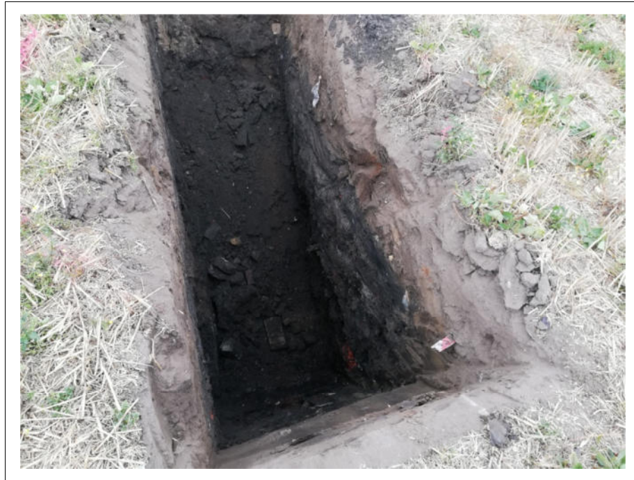
Foto 15: Schurf 5, Schurftiefe 3,10 m, Auffüllung durchhörtert, kein Sickerwasser (18.08.2022).
