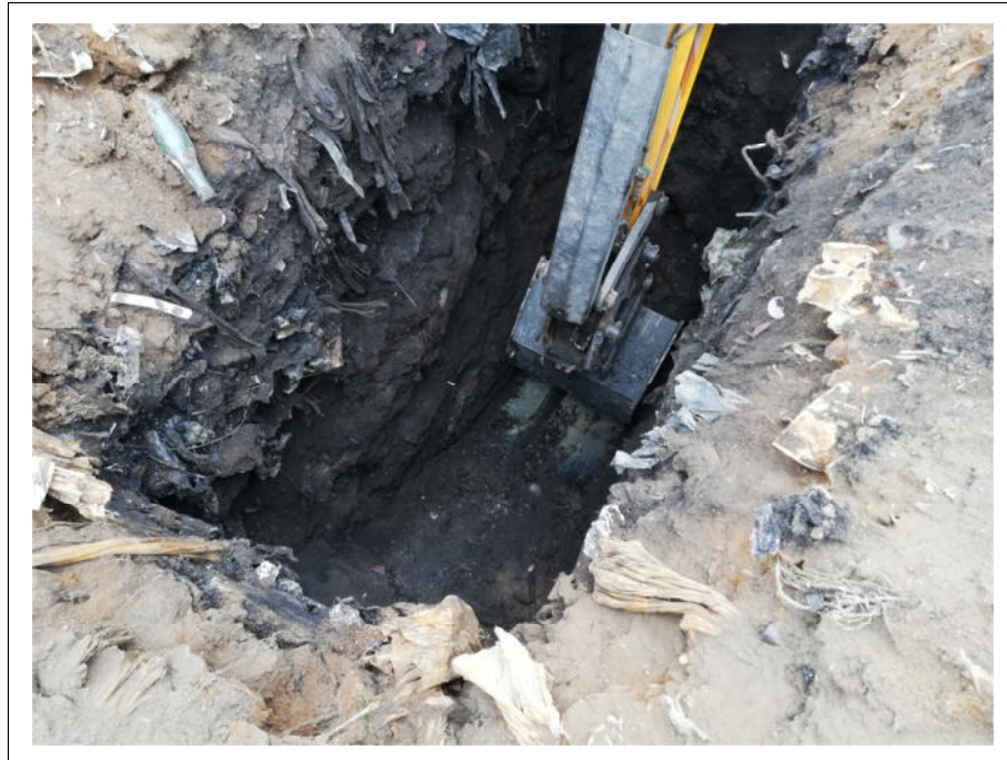
Foto 5: Schurf 1, ab 3,0 m u. GOK Lehm, kein Sickerwasser (18.08.2022).
