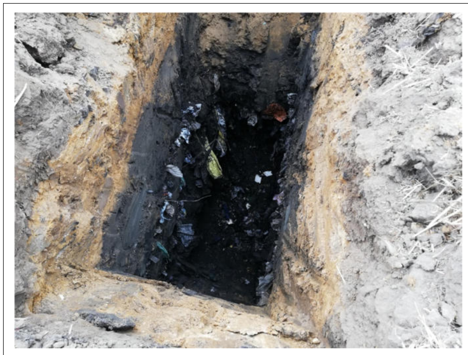
Foto 12: Schurf 3, max. Schurftiefe 4,0 m, Auffüllung nicht durchhörert, kein Sickerwasser (18.08.2022).
