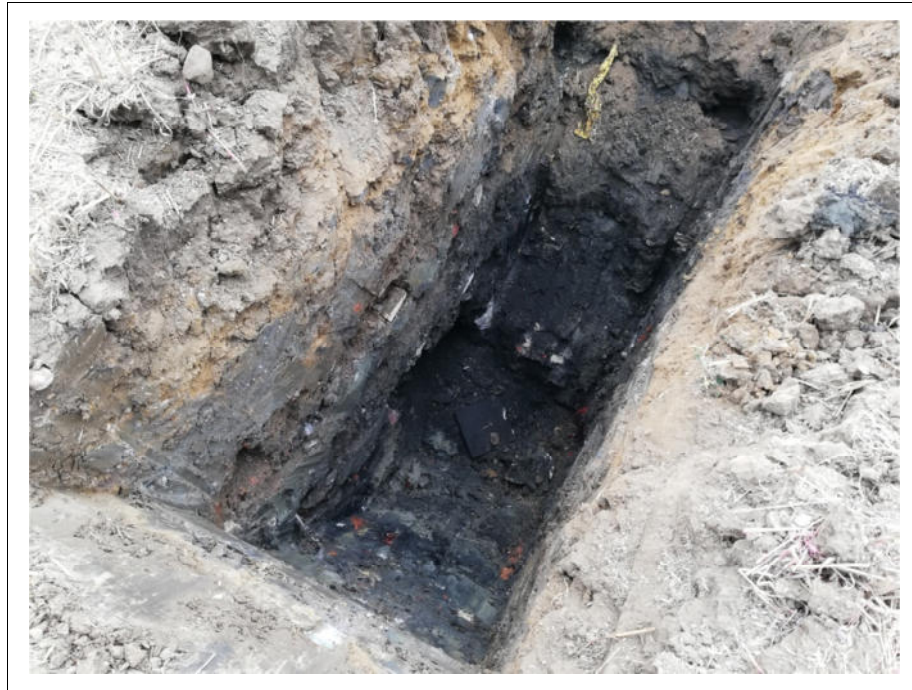
Foto 19: Schurf 7, Schurftiefe 3,0 m, Auffüllung durchörtert, kein Sickerwasser (18.08.2022).
