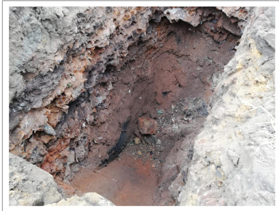
Foto 9: Schurf 2, ab 2,8 m u. GOK Lehm, kein Sickerwasser (18.08.2022).
