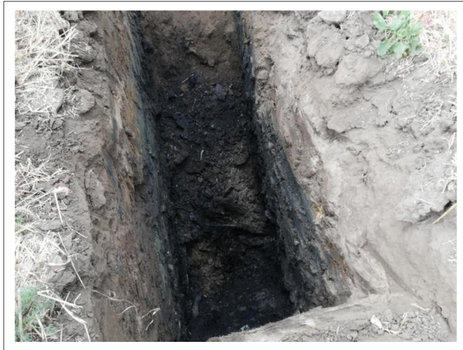
Foto 13: Schurf 4, max. Schurftiefe 4,0 m, Auffüllung nicht durchhörtert, kein Sickerwasser (18.08.2022).
