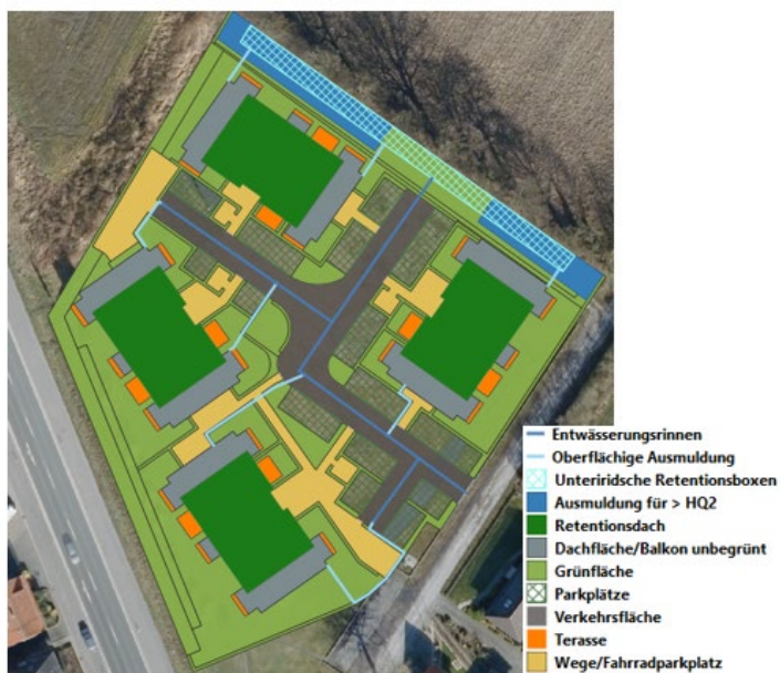
Abbildung 6: Variante 3 – Vollständige Entwässerung über Rinnen in Kombination mit Mulde und unterirdischen Retentionsboxen
