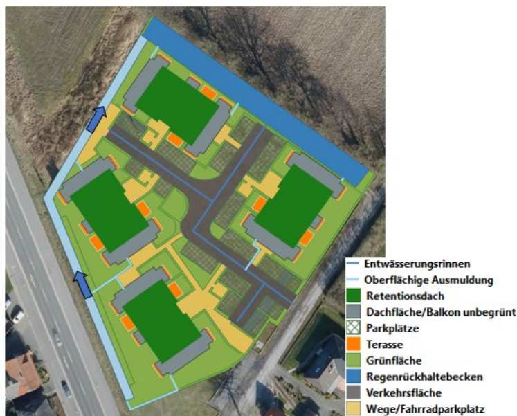
Abbildung 5: Variante 2 – Entwässerung über Rinnen und Zubringermulde in Kombination mit einem RRB
