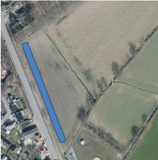
Abbildung 5: Realisierung des RRBs als langes Becken parallel zur Altenberger Straße
